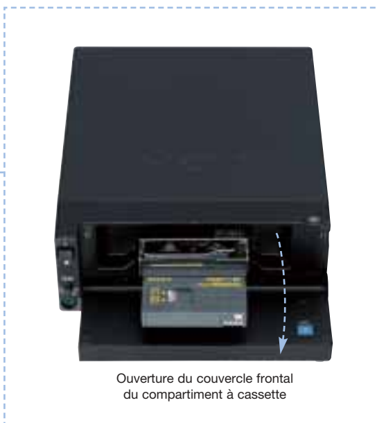
Ouverture du couvercle frontal du panneau avant
